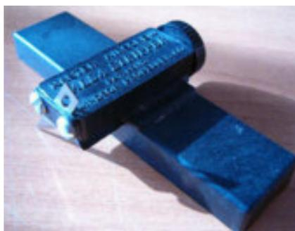
Lo stripper è uno strumento utilissimo perché vi consente di tagliare strisce di materiale con estrema precisione. È dotato di una base contro la quale batte il materiale da tagliare e di una lama collegata ad una vite micrometrica.
