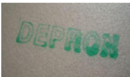
A proposito di ciò, sappiate che nella piegatura il depron si comporta esattamente come la balsa. Il senso di piegatura deve essere parallelo alla vena; piegare il depron come la balsa nel senso ortogonale alla vena può portare alla rottura se non si usano particolari accorgimenti che vedremo più avanti.
