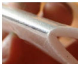
FOTO8 Ecco una piegatura stretta senza rotture
