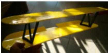
FOTO15 Esempio di ala rivestita in nastro da pacchi colorato
